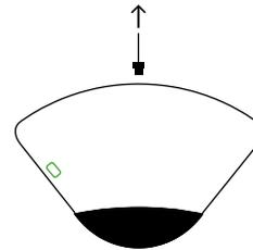
Déconnecter le câble USB-C. **Fn** clignote en **vert**. Sans câble, **TiPY™** cherche automatiquement une connexion Bluetooth. Une fois le Bluetooth trouvé, suivre les instructions apparaissant sur l'écran pour connecter **TiPY™** à l'ordinateur.
